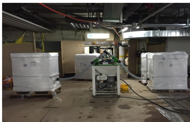
Figure 3. Pompe de mélange Inotec avec alimentation en matériau sans poussière dans des conteneurs jetables (OWC)
