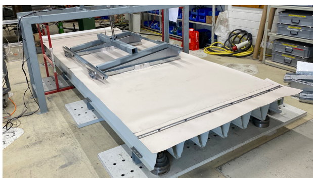
Mechanisch toegepaste uplift-belastingen naar een PV-module op twee SSM2-steunen
