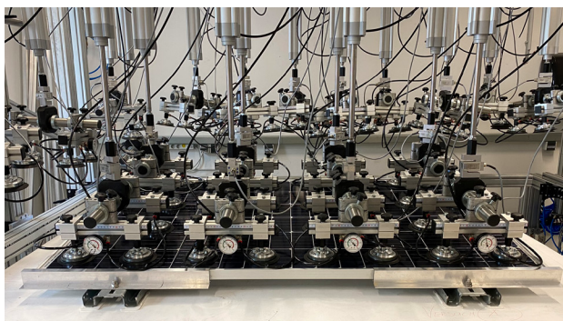
Opvoertest naar SSM2 met pneumatische cilinders
