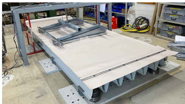
Charges de soulèvement appliquées mécaniquement à un module PV sur deux supports SSM2
