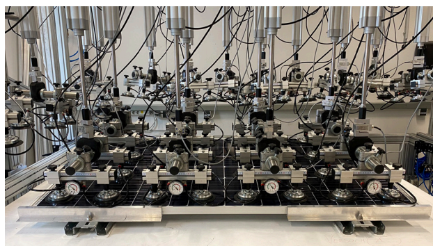
Test de soulèvement à SSM2 avec vérins pneumatiques
