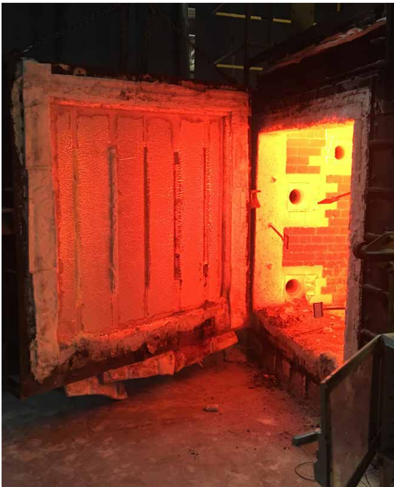
Four avec scellements linéaires verticaux après un test de résistance au feu selon EN 1366-4.
