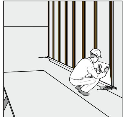
Positionnez tout d'abord le panneau de revêtement dans la position souhaitée en veillant à ce qu'il ne touche pas le ruban adhésif. Ensuite, appuyez fermement jusqu'à ce qu'il soit en contact avec le ruban adhésif SikaTack® Panel.
