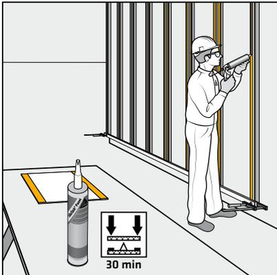
Appliquez la colle SikaTack® Panel en cordon triangulaire au moyen de la pointe triangulaire fournie (largeur de 8 mm, hauteur de 10 mm) en laissant un espace d'au moins 5 mm par rapport au ruban adhésif et au bord de la latte.
