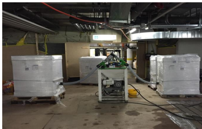
Afbeelding 3. Inotec mengpomp met stofvrije materiaaltoevoer in wegwerpcontainers (OWC)
