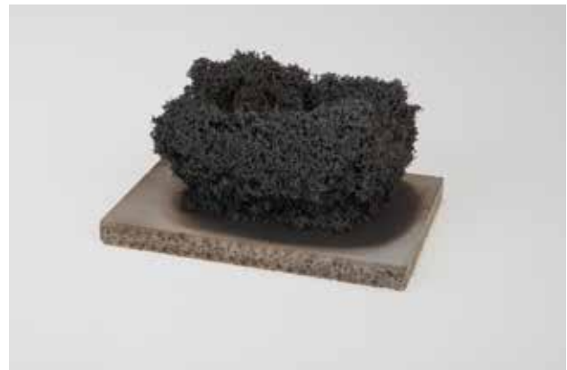
Zeer intumescente, brandwerende wikkel voor (boven) en na (onder) blootstelling aan warmte
