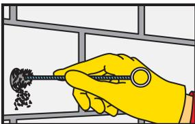
Le trou de forage doit être soigneusement nettoyé au moyen d'un goupillon spécial (minimum 2x). Le diamètre du goupillon doit être supérieur au diamètre du trou de forage.
