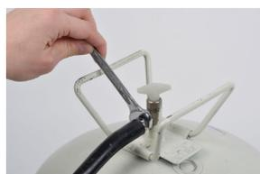
2. Fixez le tuyau tressé à la valve du bidon (à l'aide du petit écrou) et fixez l'autre extrémité du tuyau tressé au pistolet de pulvérisation (à l'aide du grand écrou). Serrez à l'aide d'une clé.
