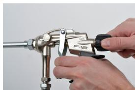
6. Ajustez le débit et la pression en tournant la valve noire du pistolet dans le sens inverse des aiguilles d'une montre jusqu'à obtenir un cordon de mousse d'une largeur de ~30 mm est atteinte
