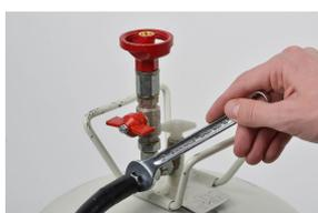
3. Fixez l'ensemble à la valve. Veillez à ce que l'ensemble reste en position verticale pendant que l'écrou est serré. Fixez le tuyau à l'ensemble. Veillez à ce que l'ensemble reste en position verticale lorsque l'écrou du tuyau est serré.
