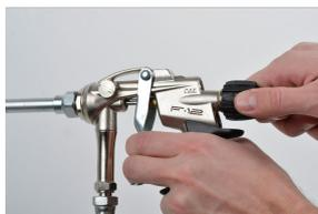
1. Éteignez le pistolet de pulvérisation en tournant la vanne noire dans le sens des aiguilles d'une montre jusqu'à ce qu'elle soit complètement fermée.
