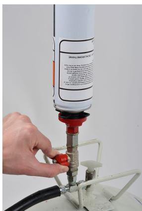
4. Vérifiez que le robinet de l'assemblage est fermé avant d'appliquer le Sika Spray Cleaner. Vissez le bidon de Sika® Spray Cleaner dans le haut de l'ensemble et ouvrez la valve rouge.
