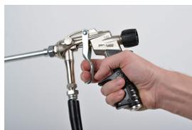
5. Dirigez le pistolet de pulvérisation dans un récipient à déchets, appliquez une pression sur la gâchette du pistolet pour pousser le Sika® Spray Cleaner à travers le tuyau et le pistolet jusqu'à ce que l'adhésif commence à se distribuer. Maintenez la pression sur la gâchette jusqu'à ce que le tuyau et le pistolet soient bien nettoyés.
