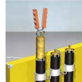
A l'aide d'une tenaille, couper juste en dessous de la bague métallique.
