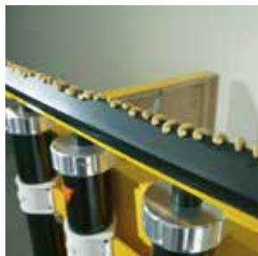
Après l'application, extruder quelques cordons de colle et les laisser polymériser attachés à la tête.
