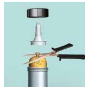
Placer la poche de colle SikaBond® dans le pistolet, découper l'extrémité et refermer le pistolet avec l'embout prédécoupé.
