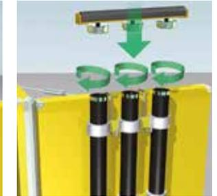
Remonter l'épandeur et serrer correctement les bagues.
