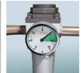
La quantité de colle appliquée peut être réglée soit par la pression donnée par le compresseur, soit par le régulateur de pression se trouvant au milieu du cylindre central ou par la vitesse de travail/marche
