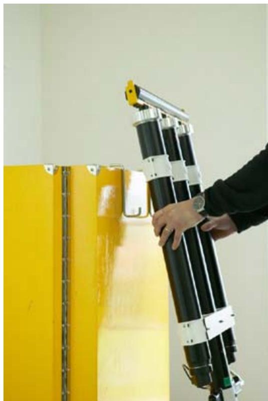
Ouvrir la valise et placer la barre de verrouillage pour stabiliser la valise. Pendre le Dispenser aux deux crochets (voir ci-dessus).
