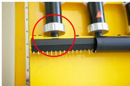
Extruder quelques "cordons de colle" et les laisser polymériser. Ces "cordons de colle" sont extrudés pour le nettoyage.
