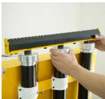
2. Dévisser les trois anneaux filetés et retirer la tête des cylindres, retirer les trois poches de colle vides et les remplacer par des nouvelles.
